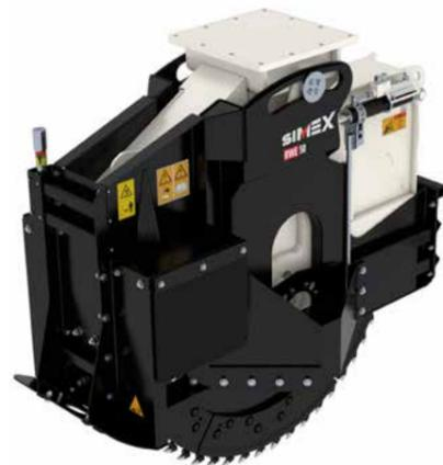
Diseñadas para el montaje en brazo excavador, están especialmente indicadas para **cortes y excavaciones de pequeña sección** destinadas al **tendido de fibra óptica** en superficies duras y compactas como **asfalto, cemento o roca**. Patines paralelos al suelo. **Profundidad de excavación constante, siempre**. Regulación de la profundidad de excavación mecánica o hidráulica.
